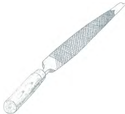
Figuur 11. Draaibeitel van halfronde vijl gemaakt
